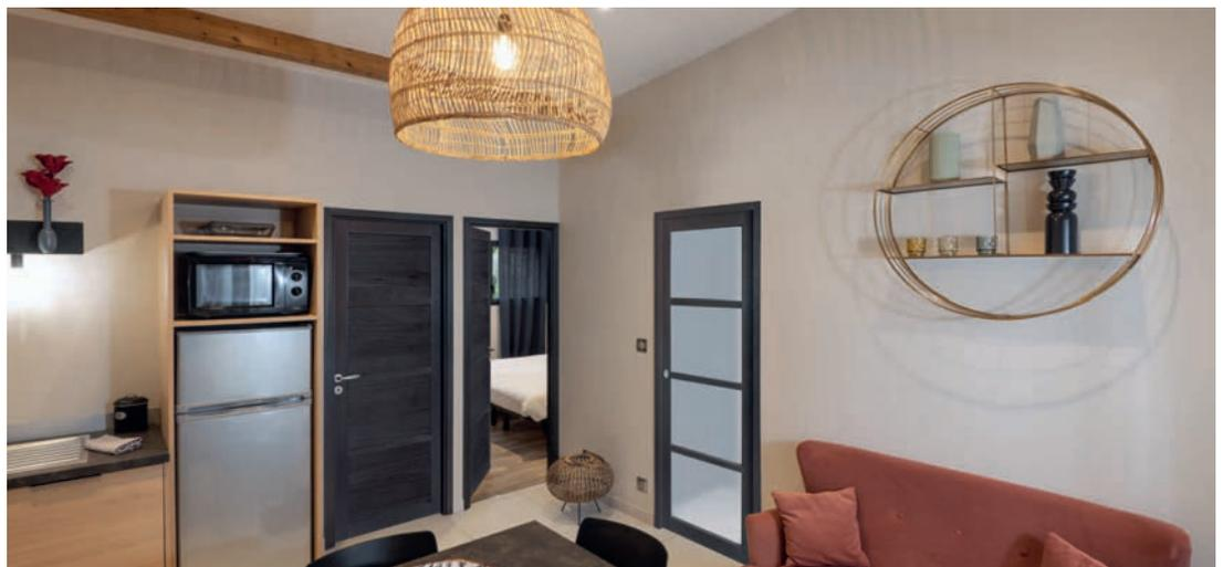
Descriptif technique: Huisserie revêtue d'un parement en bois exotique sur porte finie et enrobée blanc sur porte prépeinte. Panneaux plats (ép. 16 mm) recouverts d'un placage en bois exotique. Vitrage feuilleté dépoli 6 mm posé sur Jazz.
